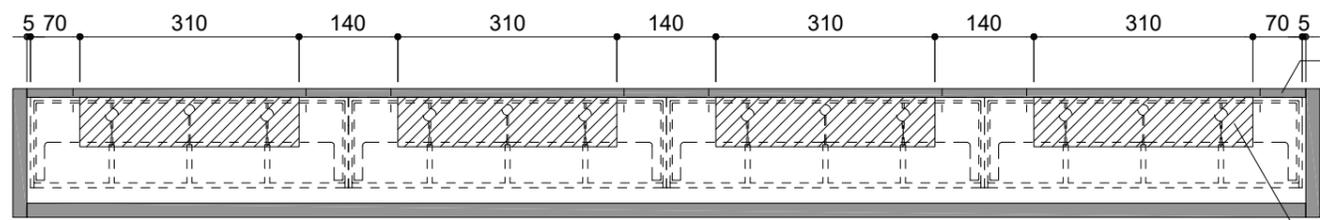
ユニット取付下地:ベニヤt12mm以上 ※建築工事
